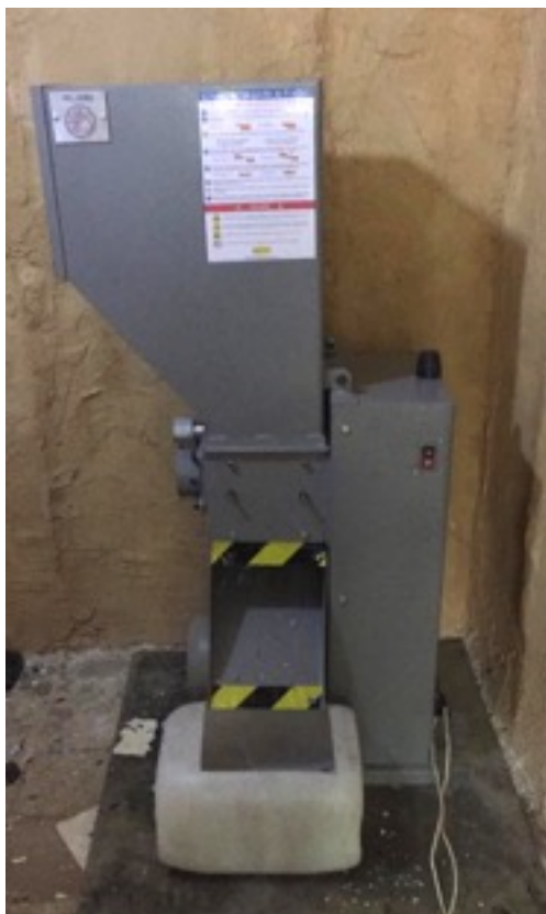
Trituradora Bifásica de plástico de 5Hp
