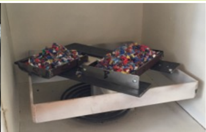
Izq: Resultado de pruebas con HDPE y PP / Izq: Molde para pruebas
